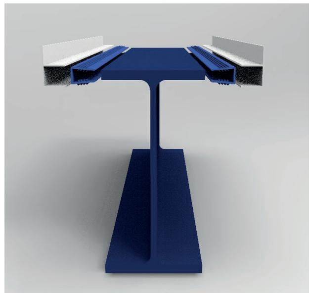
El sistema se alimenta mediante dos perfiles colocados en el ala superior de la vía con perfil aislante, sobre los cuales hacen contacto las escobillas de los carros.
