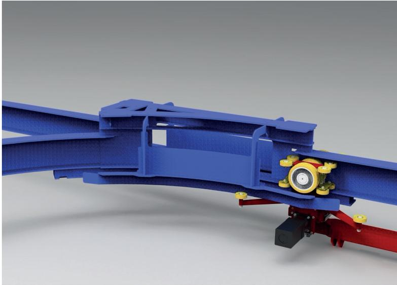
Cuando el carro entra en el switch las levas de dirección determinan la trayectoria.
